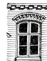
Vindue med seks ruder og murstik
